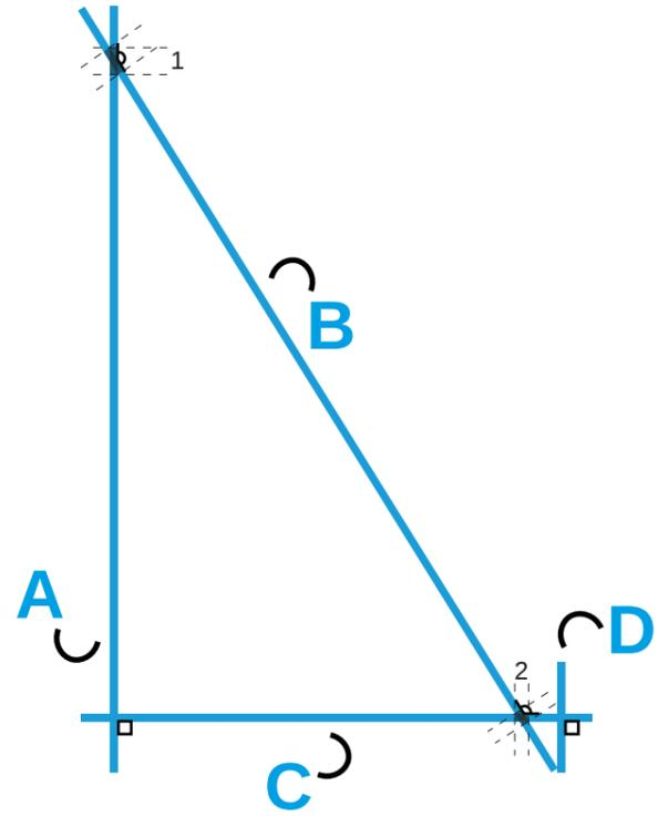
Après deux découpes et observation attentive du plan en élévation, l'angle 1 et 2 sont différents, ils ont donc besoin d'une épaisseur de fente différentes.
